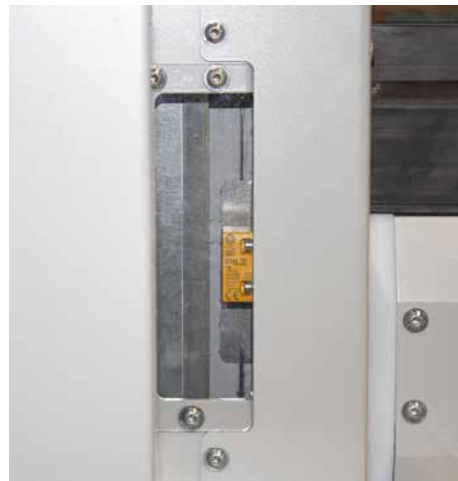
Interruptor de final de carrera de seguridad integrado
