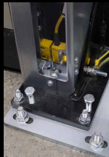
Interruptor de final de carrera de seguridad integrado
