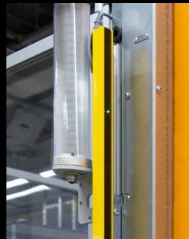
Opción de seguridad para la cabeza con rejilla de luz de seguridad
